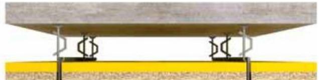
Painel montado sobre perfil T com sobreposição de uma manta de lã mineral
