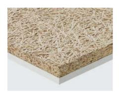
Painel de isolamento térmico e acústico, resistência ao fogo El 60, constituído por fibras de lã de madeira de abeto finas e ligadas com cimento Portland branco, de acordo com a norma EN 13168, de 25 mm de espessura, acoplado a uma camada de gesso cartonado de 15 mm de espessura, de acordo com EN 520. A espessura das fibras é de 2 mm de largura. Placas de alta qualidade para sistemas de absorção
