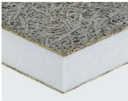
Panel de isolamento térmico e acústico, feito a partir de duas camadas (5 mm de espessura cada) de lã de madeira de abeto, mineralizadas e ligadas com cimento Portland cinzento, acoplada a uma camada interna de poliestireno extrudido de acordo com a norma EN 13164.
