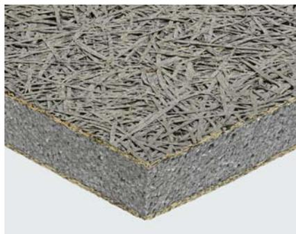
Painel de isolamento térmico e acústico feito a partir de duas camadas (5 mm de espessura cada) de lã madeira de abeto mineralizada e ligada com cimento Portland cinza, acoplado a uma camada interna de poliestireno expandido, de acordo com a norma EN 13163. Está em conformidade com a norma EN 13168. A madeira utilizada provém de florestas sustentáveis com certificação PEFC™ ou FSC®.
