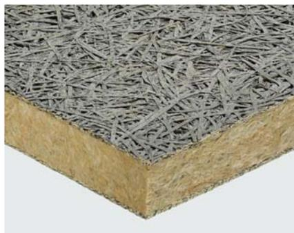
Painel de isolamento térmico e acústico específico para isolamento externo, feito a partir de duas camadas (5 mm de espessura cada) de lâ de madeira de abeto mineralizada e ligada com cimento Portland cinza, acoplado a uma camada interna de lâ mineral de alta densidade, de acordo com a norma EN 13162.
