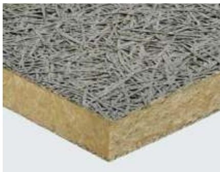
Painel de isolamento térmico e acústico, feito a partir de duas camadas (5 mm de espessura cada) de lâ de madeira de abeto, mineralizadas e ligadas com cimento Portland cinzento, acoplada a uma camada interna de lâ mineral de acordo com a norma EN 13162.
