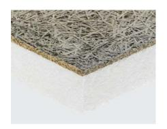
Painel de isolamento térmico e acústico feito a partir de uma camada (10 mm de espessura) de fibras de lã de madeira de abeto mineralizada e ligada com cimento Portland cinza, acoplado a uma camada de poliestireno expandido, de acordo com a norma EN 13163. Está em conformidade com a norma EN 13168.
