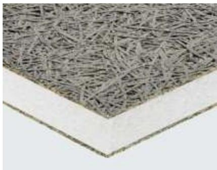
Painel de isolamento térmico e acústico, feito a partir de duas camadas (5 mm de espessura cada) de fibras de lã de madeira de abeto, mineralizadas e ligadas com cimento Portland cinzento, acoplada a uma camada de poliestireno expandido de acordo com a norma EN 13163 standard.
